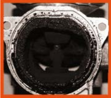
ЕГР вентил нечист
