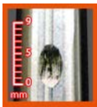
Истрошеност на металана површина под оптоварување од 23 кг, третирана со масло 5W40
