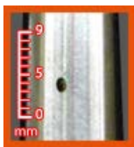
Истрошеност на металана површина под оптоварување од 23 кг, третирана со масло 5W40 +5%
